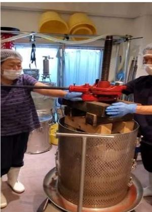
圧搾作業とは、ブドウの液体から皮と種を取り出して、この皮と種を圧搾機にかけて液体を搾り出す作業です。今回は手動の圧搾機を使用しました。
